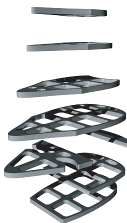
カーボンファイバーコンポジット 内部ブレイシング
